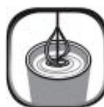
2- 使用装上搅拌桨的电钻搅拌，直到获得均匀、无块状物的混合物为止。使用刮铲将容器侧面和底面的残余产品刮下来。
