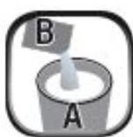
1- 将小桶中的催化剂倒入A部分（糊状）中。务必确认将全部的催化剂都倒进去。
